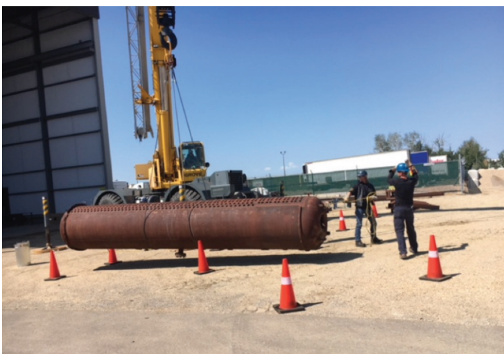
Un collecteur de vapeur. Des apprentis établissent le poids et le centre de gravité, puis ils doivent manœuvrer le collecteur sur un parcours préétabli.
